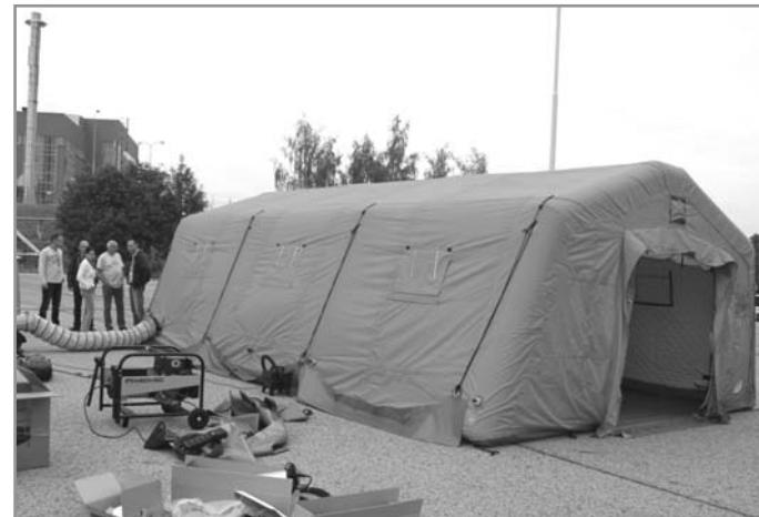
Je možné je našouknout za necelých pět minut. Jsou tepelně izolované a připravené na teploty od -30 do +60 stupňů Celsia, vichřici, nebo zatížení sněhem.
