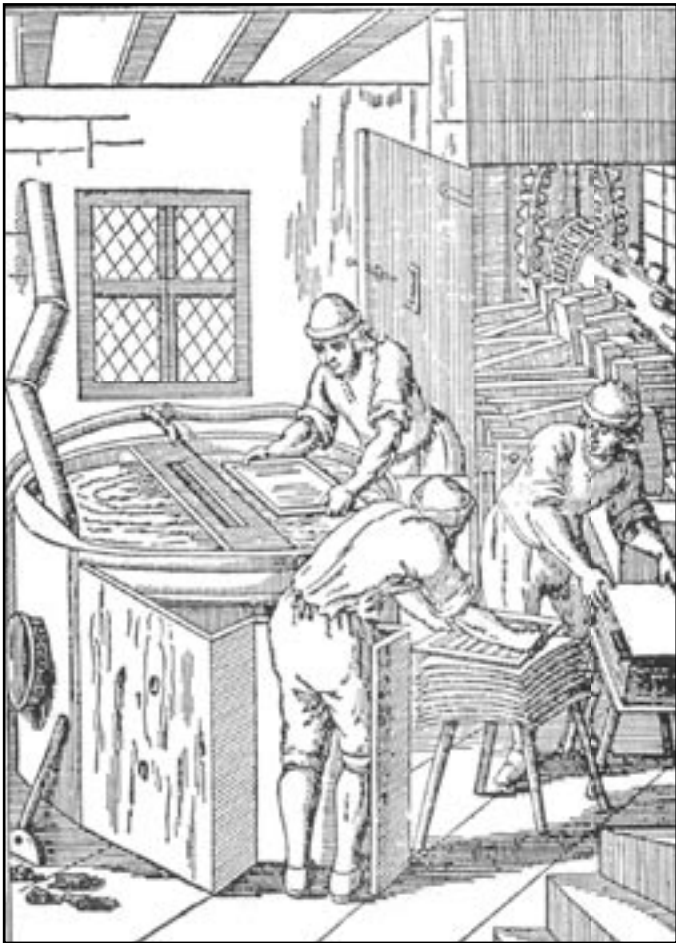
Postup výroby ručního papíru
