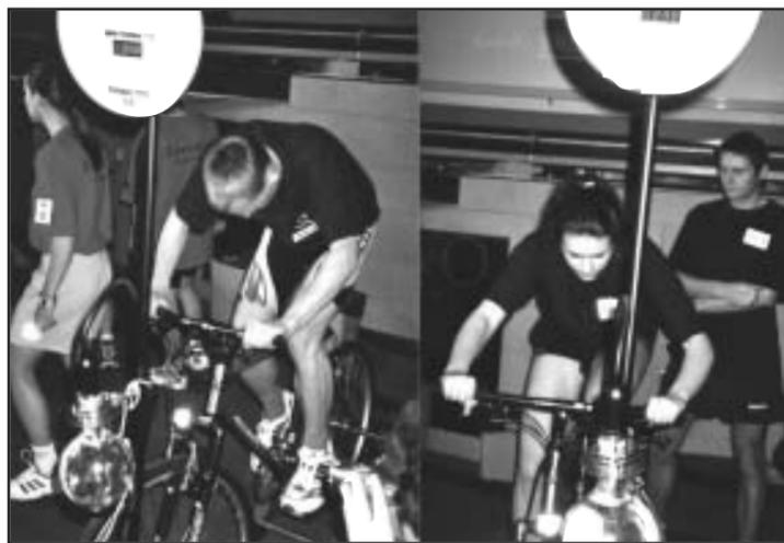
možnou teplotu prostřednictvím topné spirály ponořené do skleněné baňky a potřebný proud vyrobit vlastním pohonem generátoru zapojeného na obyčejné jízdní kolo.
